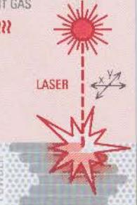
Mittels eines beweglichen Laserstrahls wird Metallpulver schichtweise selektiv lokal aufgeschmolzen und verfestigt damit einen Querschnitt des Bauteils.
