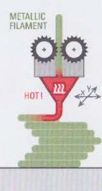
Metalldraht wird im Lichtbogen-schweissverfahren geschmolzen und schichtweise lokal aufgetragen, um schnell große end-konturnahe Metalstrukturen zu erzeugen.
