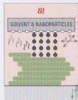
Eine Metallpartikel-Lösungsmittel-flüssigkeit wird in einer Düsen-einheit selektiv lokal dosiert. Das Lösemittel verdampft und die Nanopartikel verbinden sich.
