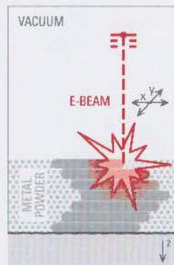
Mittels eines beweglichen Elektronenstrahls wird Metallpulver schichtweise selektiv lokal aufgeschmolzen und verfestigt damit einen Querschnitt des Bauteils.
