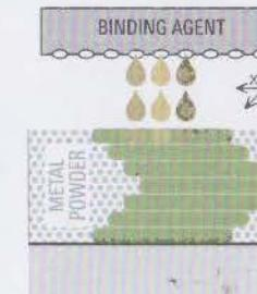
Winzige Bindemitteltröpfchen werden durch viele Düsen einheitlich selektiv lokal dosiert. Das Lösemittel verdampft und die Nanopartikel verbinden sich.
