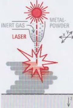
Material wird aufgebracht und simultan durch einen Laserstrahl und schichtweise durch einen Lichtbogenstrahl aufgeschmolzen. Das folgende Erstarren der Schmelze generiert neue Schichten, die über- und nebeneinander angeordnet werden.
